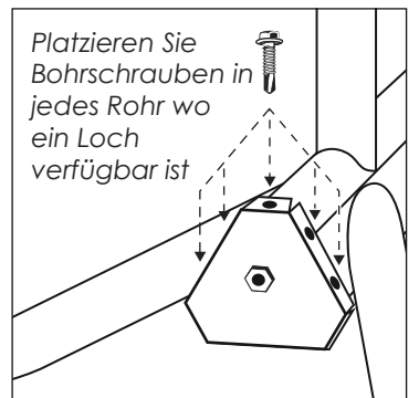
7. Befestigen Sie die Endplatten an beiden Enden der Rohre mit Bohrschrauben
